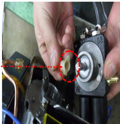
■ Соединительная муфта топливного насоса
