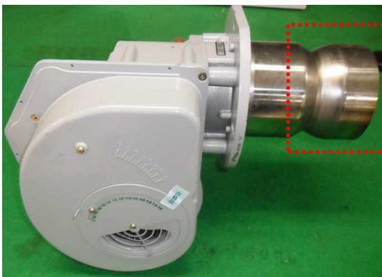
■ Отсоедините трубу горелки
