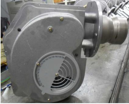
2. Проверить колесо вентилятора.
