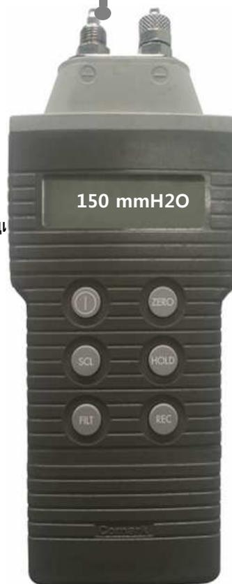
б) Способ измерения первичного давления газового котла 100 ~ 200
